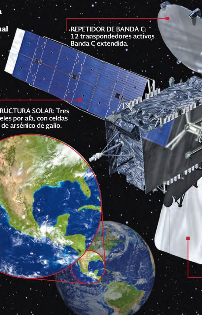
REPETIDOR DE BANDA C: 12 transpondedores activos Banda C extendida.
